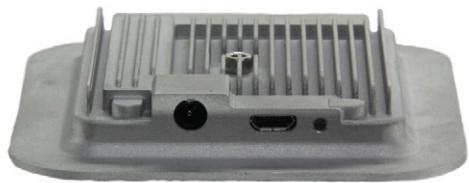
Obrázek A-3: Vlevo - napájení, Uprostřed - Micro USB, Vpravo - dioda LED
